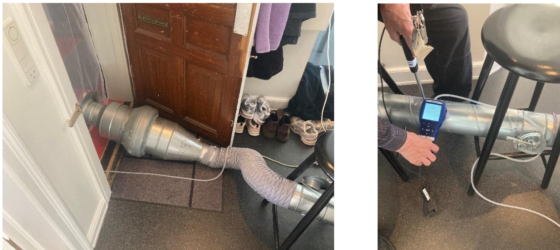
Figur 1: Trykprøvning af lejligheden Julius Bloms Gade 13, 4.th. Der var en udsuget luftmængde på ca. 510 m 3 /h
